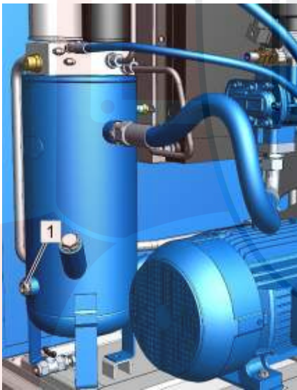
Рис. 31: Проверка уровня охлаждающей жидкости через смотровое отверстие
