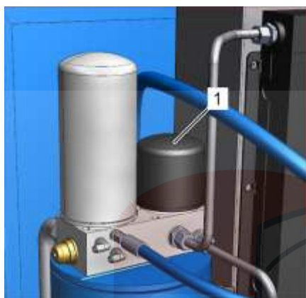
Рис. 42: Демонтаж масляного фильтра
