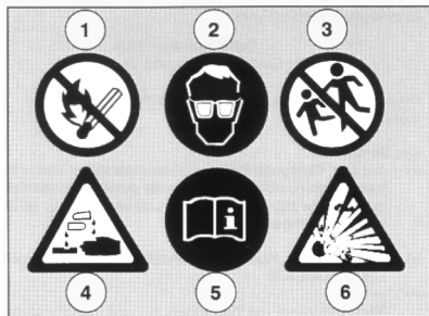
Предупреждающая наклейка на батарее
