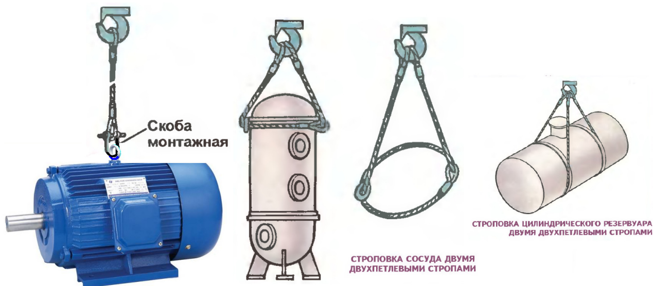
Рисунок 29 – Схема строповки агрегатов компрессорной установки
