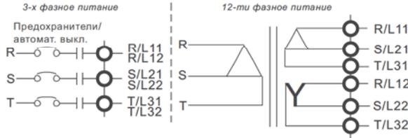
Для снижения уровня пульсаций и гальванической развязки ПЧ и питающей сети, а также для удобства подвода питания 6-ю проводами меньшего сечения (вместо трех проводов, как в классической схеме) в типоразмерах G и H предусмотрена возможность питания от 6-ти выходных обмоток трансформатора (трансформатор в комплект поставки не входит).
