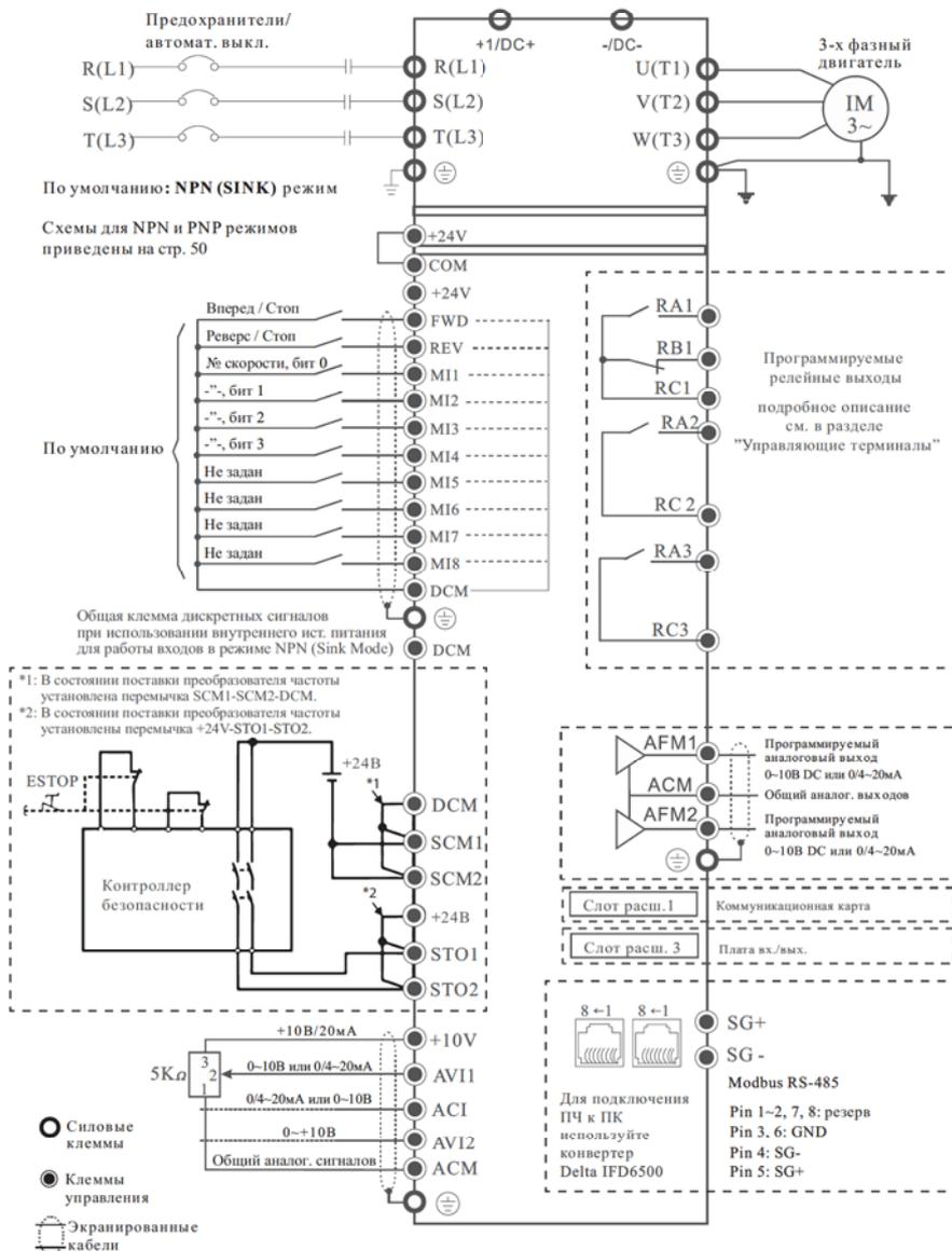
**Рисунок 1. Входные клеммы для типоразмеров G и H**
